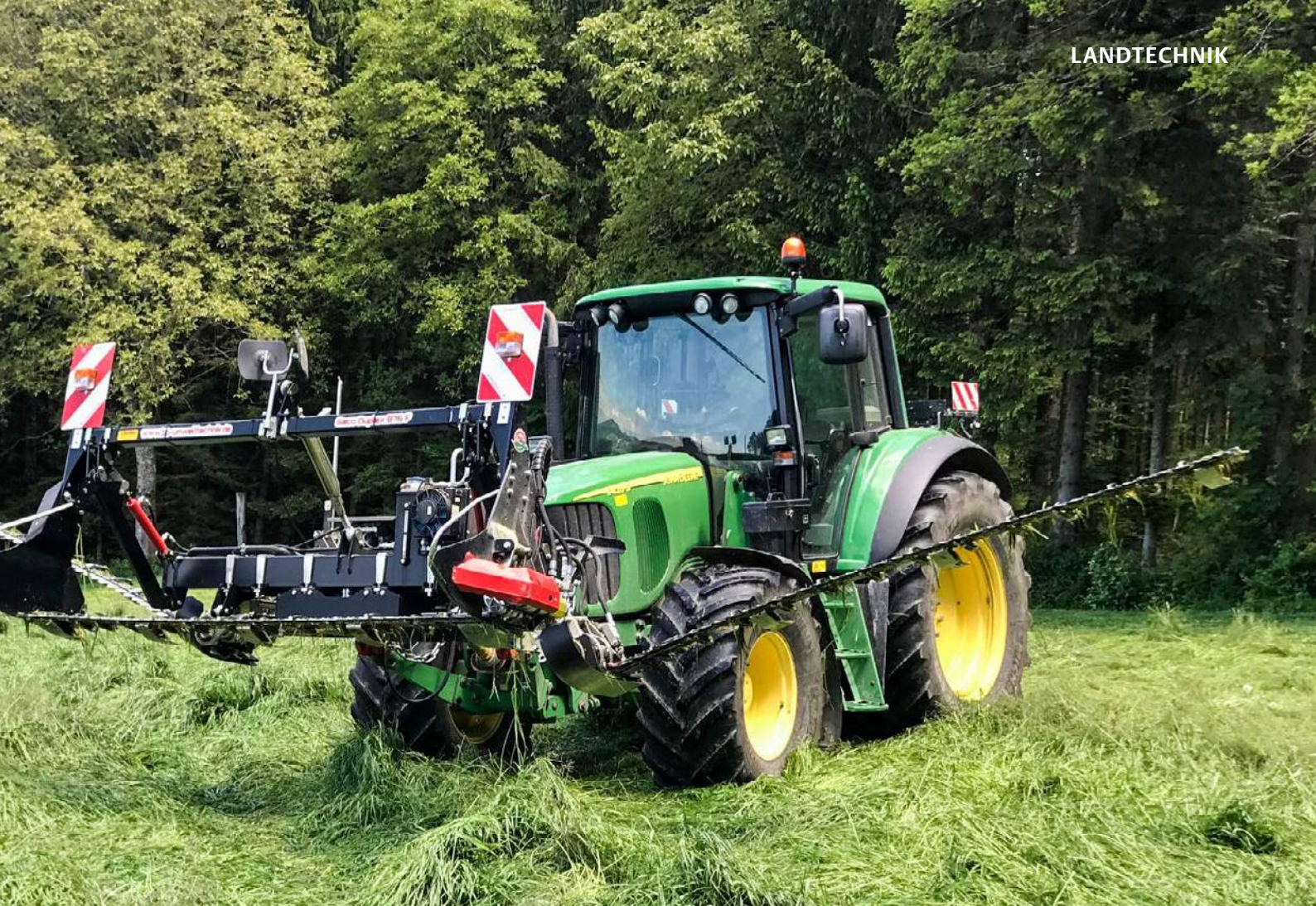
Ein mit einem Doppelmesserbalken ausgestattetes Schmetterlingsmäherwerk ist leicht und leistungsstark. Bild: Urs Kümmerli
