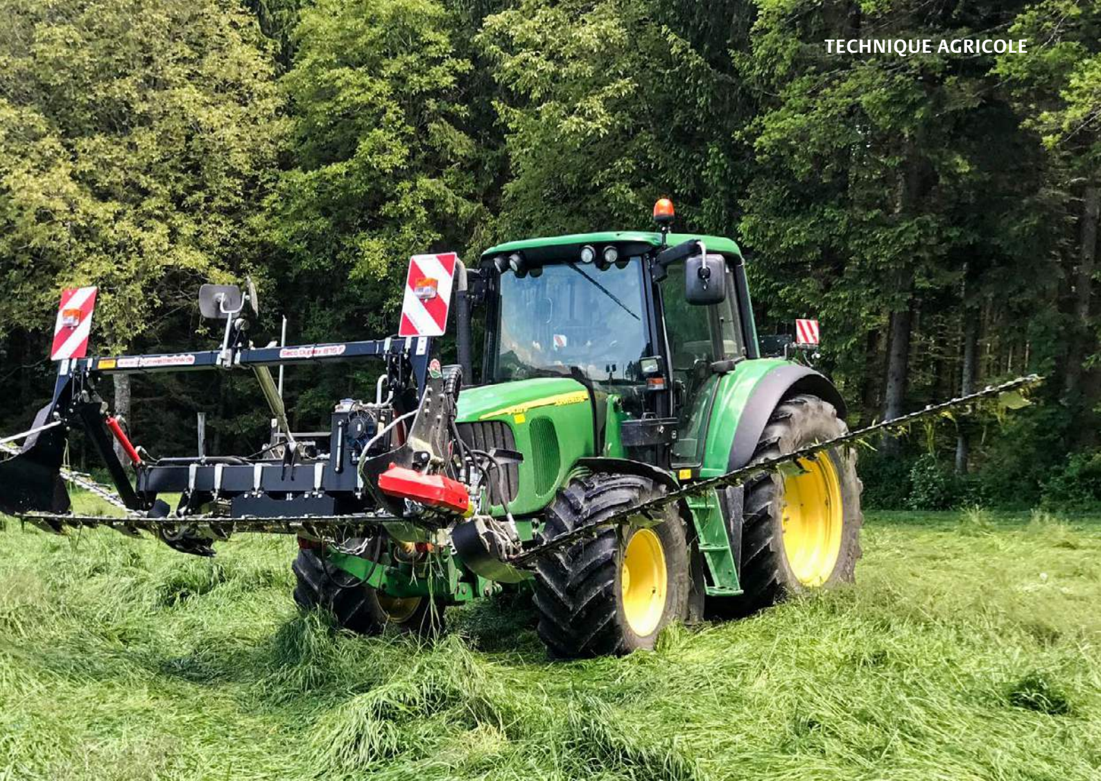
Une faucheuse papillon avec une barre de coupe à double lame est légère et performante. Photo: Urs Kümmerli
