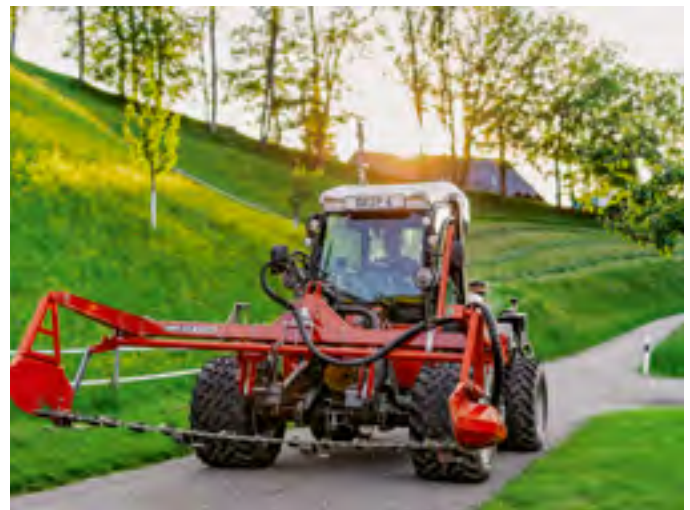
Les barres de coupe à double lame pour faucheuses à deux essieux sont modulables jusqu'au «papillon» composé de trois parties.
