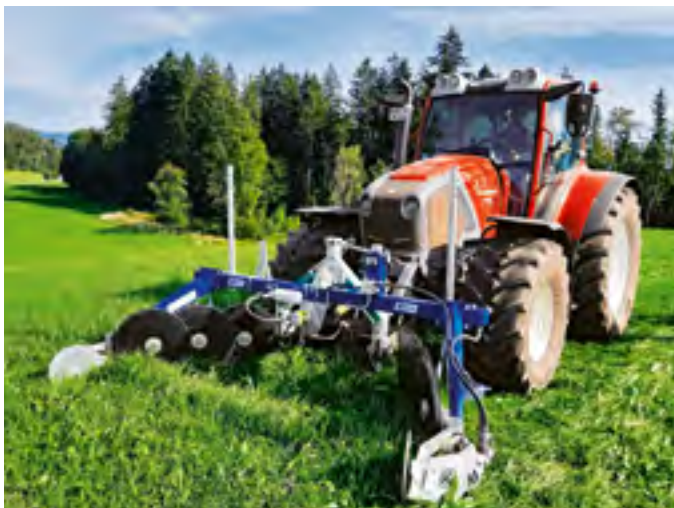
Les disques d'andainage de la faucheuse frontale évitent que le tracteur passe sur le fourrage.
