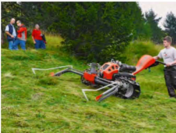
Il est possible de faucher en épargnant les insectes. Tous les constructeurs proposent les barres de coupe à double lame.
