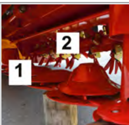
Les disques (1) ou tambours à rotation horizontale causent 5% des pertes d'abeilles dues aux faucheuses rotatives, contre 57% pour l'arbre de rotor (2) ou les rouleaux de broyage. (Agroscope).
