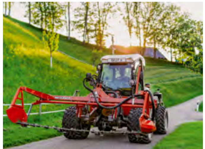
Doppelmessermähwerke für Zweiaxsmäher sind modular ausbaubar bis zum dreiteiligen «Schmetterling».
