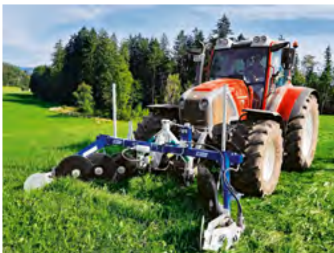
Schwadscheiben am Frontmähdwerk verhindern ein Überfahren des Futters durch den Traktor.
