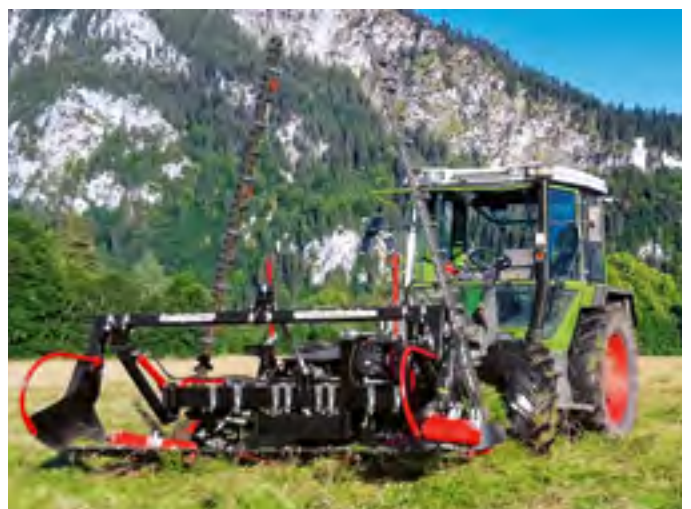
Dieses klappbare Frontanbau-Doppelmessermähwerk hat eine Arbeitsbreite von 9 m.
